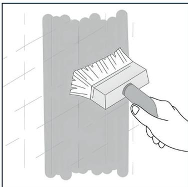
**Appliquez généreusement la colle directement sur le mur, sur la largeur d'un lé, à l'aide d'un rouleau spécial colle intissé ou d'une brosse à encoller.**
