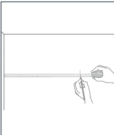
Identifiez l'emplacement du premier lé. Il doit être posé à **une distance suffisante d'un angle, d'une porte ou d'une fenêtre** afin de commencer bien **droit**, sur un **pan de mur complet** (du plafond au sol).
