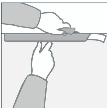
A l'aide d'une règle, **découpez le bord du papier peint le long du plafond, des plinthes, des arêtes des murs et également pour détourer les fenêtres et portes.**
